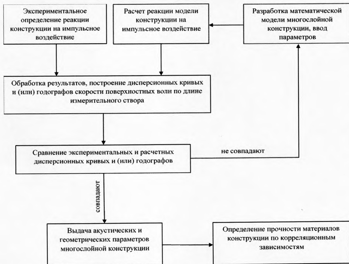
Рис. 2.1. Блок-схема алгоритма контроля состояния многослойных конструкций
