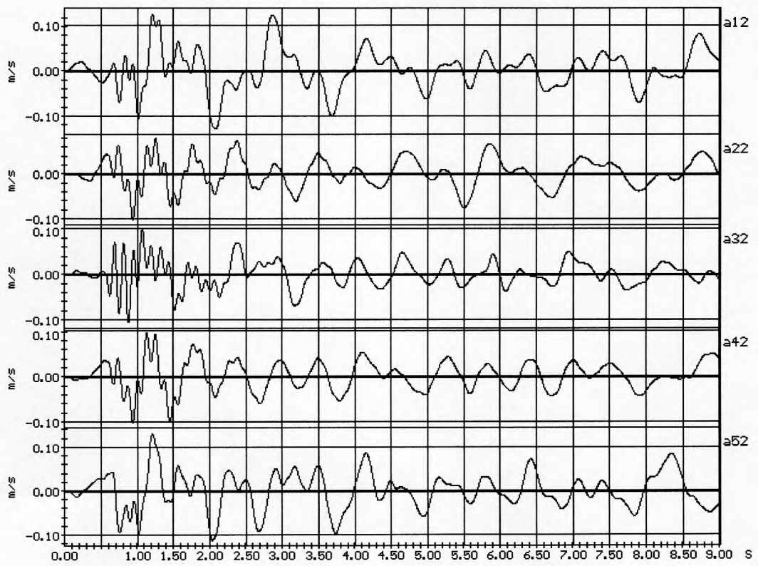
Рис. 1.5. Колебания здания при ударе У2
