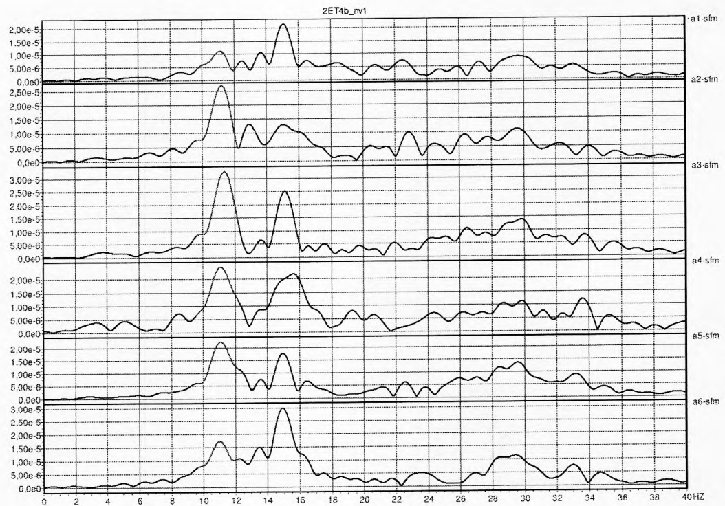
Рис. 11. Модули спектров Фурье реакции обследованного перекрытия на комбинацию ударных воздействий, выделена 1-я форма колебаний
