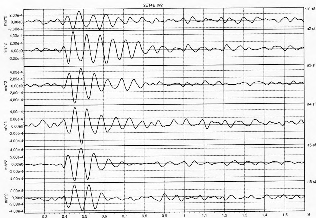
Рис. 13. Пример реакции перекрытия на комбинацию ударных воздействий U_1-U_2+U_3-U_4+U_5-U_6 для выделения 2-й формы колебаний
